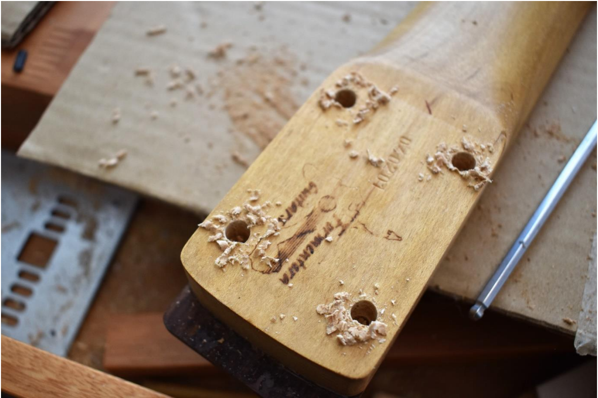
Geschafft, alle 4 Löcher sind gebohrt. Jetzt die Spuren entfernen...
