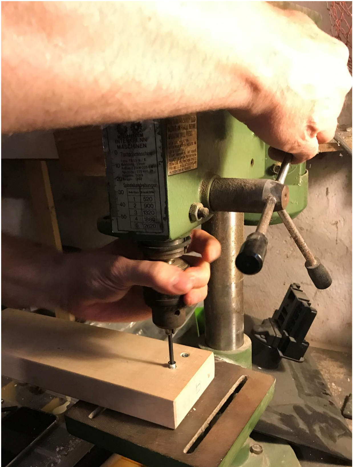
Jetzt werden die Schraubeinsätze montiert...
