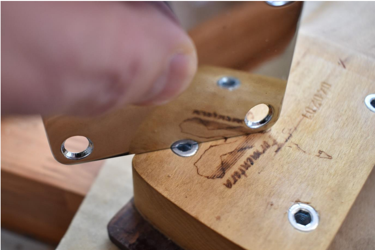
Überprüfe, dass die Einsätze nicht überstehen!
