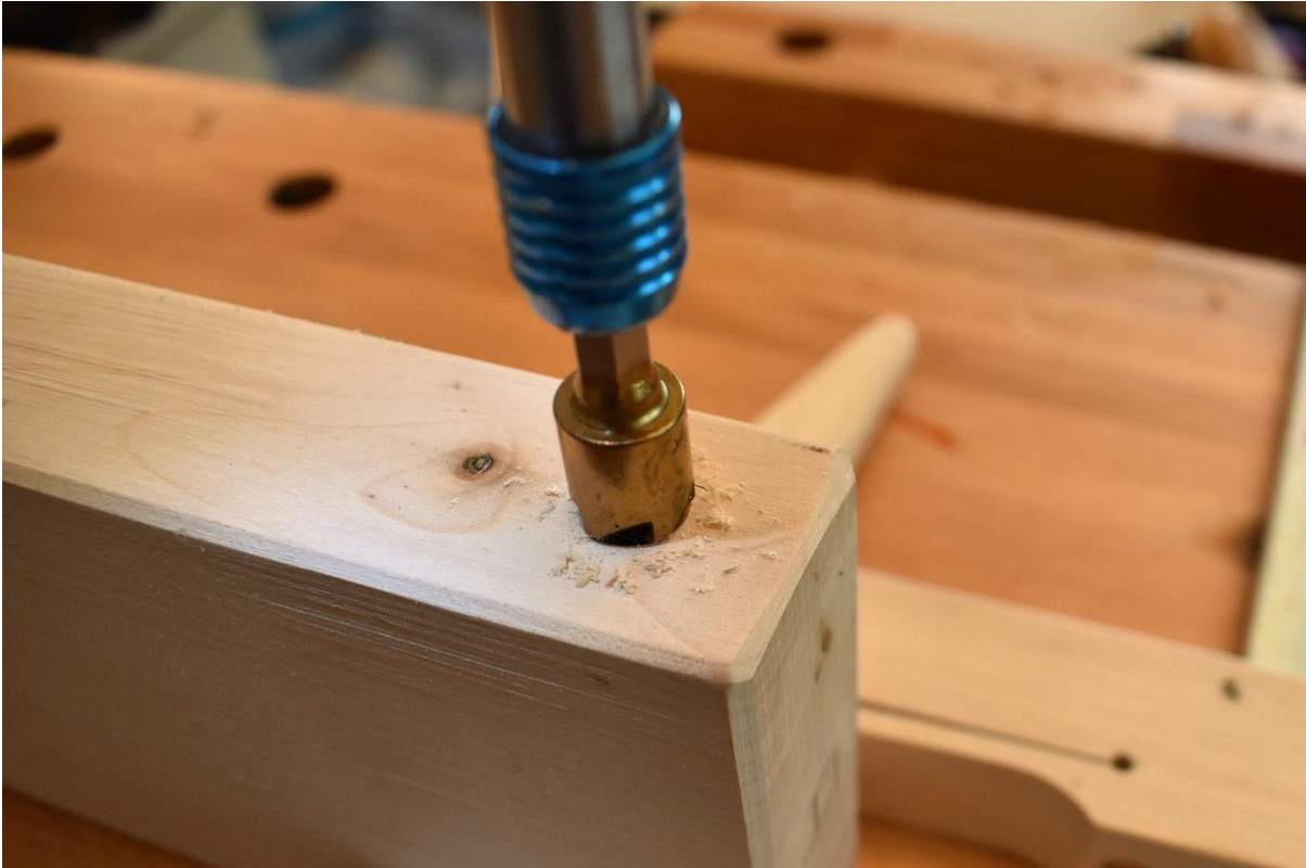
Wir bohren nur einen kleinen Absatz für den „Kragen“ des Inserts.
