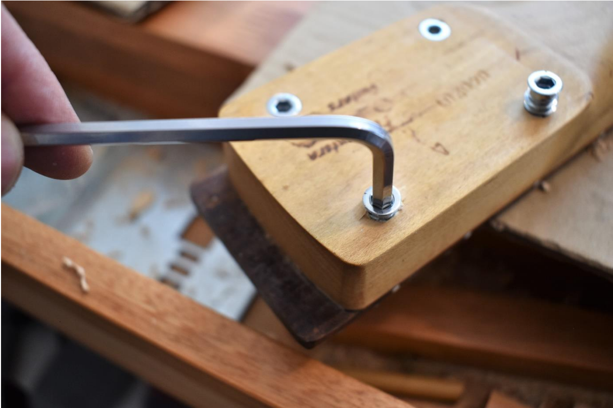
Wenn Du es mit Handwerkzeugen machen musst: Pass auf, dass die Einsätze von Anfang an senkrecht eingeschraubt werden.
